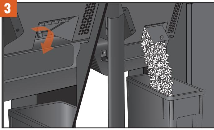
Dévissez le bouton situé à l'arrière de la boîte de tarière et ouvrez la porte de libération des granulés. Les granulés se videront dans le bac à granulés StayDry<sup>MC</sup>. Aspirez la sciure de bois restante dans la trémie.
