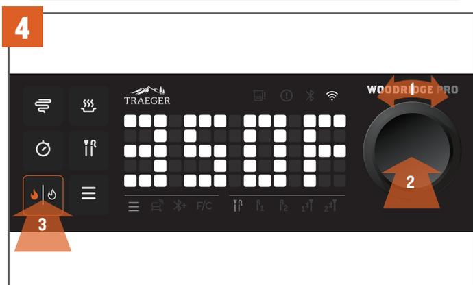
Tournez le cadran de sélection pour régler la température du barbecue sur 350 °F (177 °C), puis appuyez sur le cadran. Appuyez sur le bouton d'allumage/arrêt.
