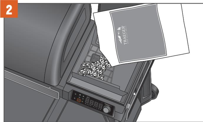
Pour ajouter des pellets, ouvrez le couvercle de la trémie et vérifiez qu'aucun corps étranger ne se trouve dans la tarière. Remplissez la trémie de pellets au moins jusqu'à la grille de sécurité et fermez le couvercle.
