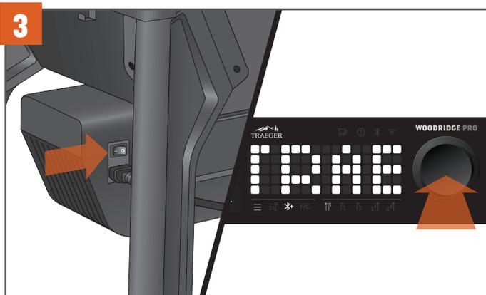
Appuyez sur l'interrupteur principal, situé à l'arrière de la boîte de tarière, pour le mettre sur ON (MARCHE) (1). Appuyez sur le bouton de sélection pour activer l'appareil de contrôle. Le mot « TRAEGER » défile sur l'écran, indiquant que le barbecue est en marche.
