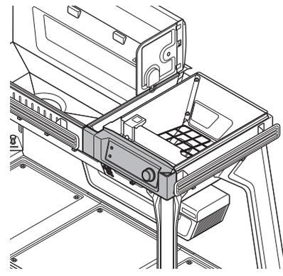
**CONSEIL DE PRO :** Pour faciliter le branchement, posez l'appareil de contrôle sur le dos, sur le bord de la trémie.
