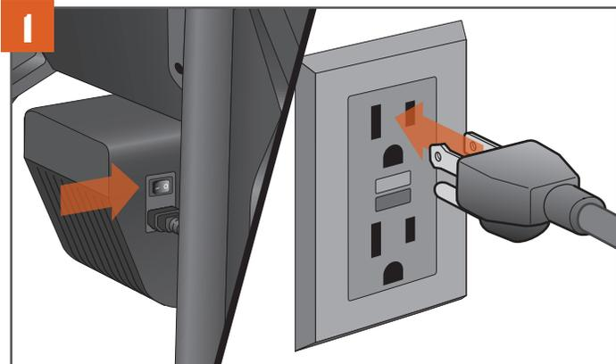
Lorsque l'interrupteur principal est en position OFF (ARRÊT) (0), branchez le cordon d'alimentation à votre barbecue. Branchez ensuite le cordon d'alimentation dans une prise électrique correctement mise à la terre et protégée par un disjoncteur différentiel de fuite à la terre (GFCI).
