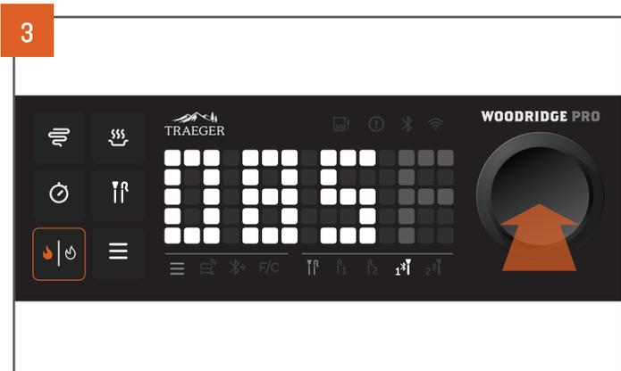
Lorsque le thermomètre à viande, souhaitée est mise en surbrillance dans la barre de menu de la sonde sous l'écran à matrice de points (sonde 1 illustrée ci-dessus) et que la température actuelle du thermomètre à viande est affiché, appuyez sur le bouton de sélection et maintenez-le enfoncé pendant trois secondes.
