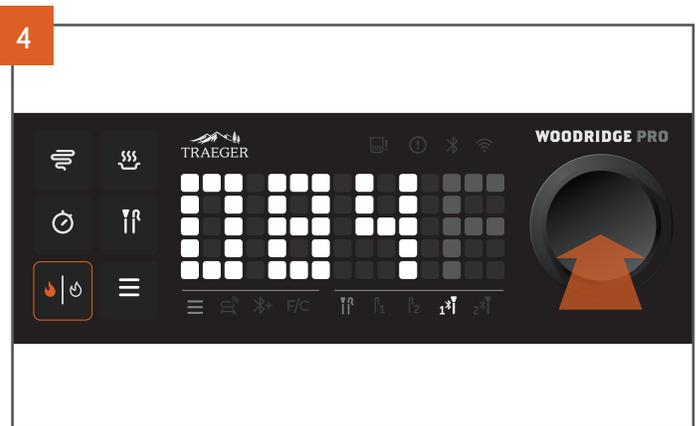
Lorsque la sonde souhaitée est mise en surbrillance dans la barre de menu de la sonde (dans cet exemple, la sonde Bluetooth<sup>MD</sup> I), appuyez sur le cadran de sélection pour la sélectionner.
