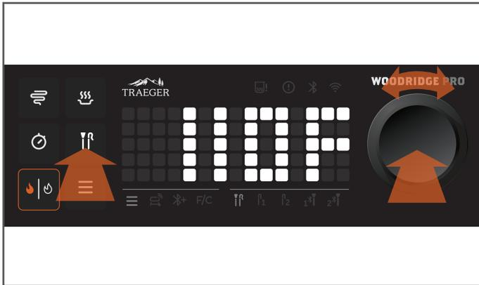
**MODIFIER :** Si vous souhaitez modifier une alarme d'objectif de température de sonde en cours, appuyez simplement sur le bouton de la sonde, tournez le cadran de sélection pour mettre en surbrillance la sonde souhaitée dans la barre de menu de la sonde et appuyez sur le cadran. Tournez le cadran de sélection jusqu'à la température souhaitée et appuyez pour verrouiller votre réglage.
