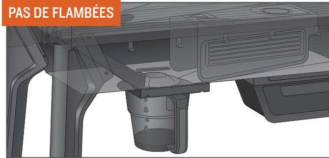
Toute la graisse est canalisée en toute sécurité dans le bac à graisse et à cendres EZ-Clean<sup>MC</sup> pour être éliminée. Ceci, combiné à un entretien régulier, empêche les flambées et les boules de feu désagréables de détruire vos aliments.
