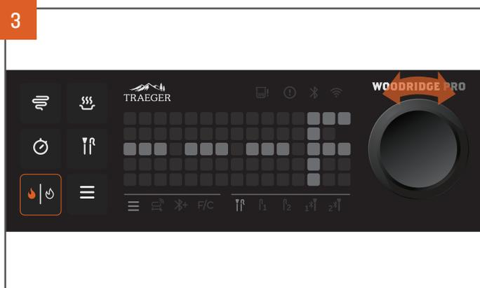
Pour sélectionner une température, tournez le cadran de sélection vers la droite pour augmenter la température, ou vers la gauche pour la diminuer.
