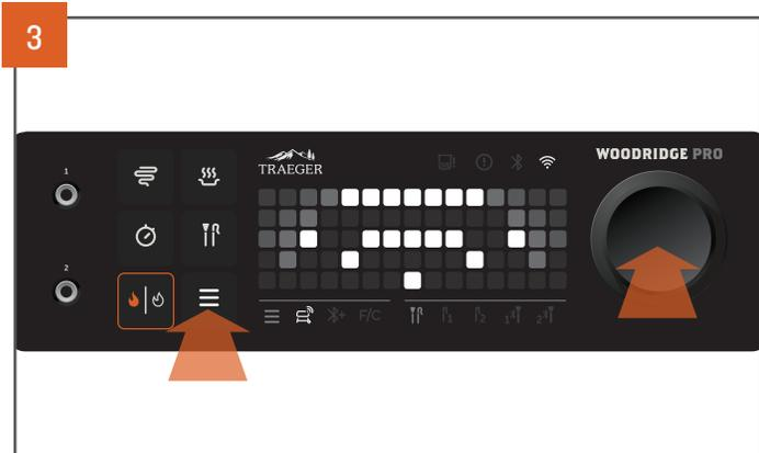
Après avoir allumé votre barbecue, appuyez sur le bouton de menu. Vous verrez l'icône Wi-Fi barbecue s'allumer dans la barre de menu sous la matrice de points, et une animation d'un signal Wi-Fi avec un point d'interrogation s'affichera. Appuyez sur le cadran de sélection pour sélectionner cette option et commencer le processus de connexion.
