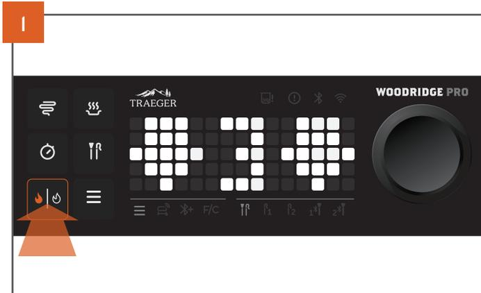
Appuyez sur le bouton d'allumage/arrêt et maintenez-le enfoncé pendant trois secondes. Votre appareil de contrôle effectue alors un compte à rebours à partir de 3. Lorsqu'il atteint 0, le cycle d'arrêt commence.
