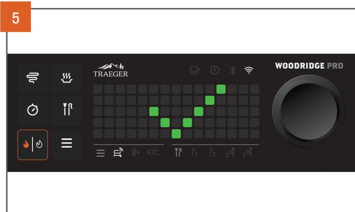
Une coche verte s'affiche sur votre appareil de contrôle pour indiquer que vous vous êtes connecté avec succès à WiFIRE<sup>MD</sup>. L'icône Wi-Fi en haut à droite au-dessus de l'écran matriciel reste allumée lorsque le barbecue est connecté.
