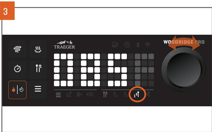
Dans le menu des sondes, utilisez le cadran de sélection pour parcourir et mettre en surbrillance toutes les sondes actuellement connectées et actives. L'icône s'allume dans la barre de menu de la sonde et la température actuelle de la sonde s'affiche.
