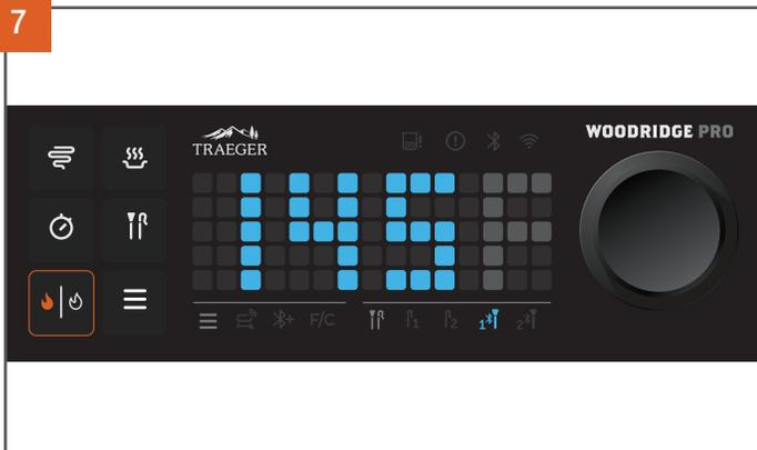
La température cible affichée à l'écran devient bleue lorsque la sélection est confirmée. Une fois l'objectif confirmé, l'écran affiche alternativement la température cible (en bleu) et la température actuelle de la sonde (en blanc) lorsque cette sonde est mise en surbrillance. L'icône de la sonde dans la barre de menu de la sonde devient bleue pour indiquer qu'un objectif a été fixé. Le régulateur vous avertit lorsque vous avez atteint la température cible.
