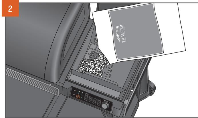
Pour ajouter des granulés, ouvrez le couvercle de la trémie et vérifiez qu'aucun corps étranger ne se trouve dans la tarière. Remplissez la trémie de granulés au moins jusqu'à la grille de sécurité et fermez le couvercle.
