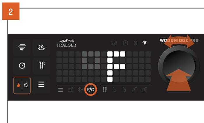
Tournez le cadran de sélection jusqu'à ce que l'icône « F/C » s'allume dans la barre de menu. Appuyez sur le cadran pour accéder au mode de sélection.
