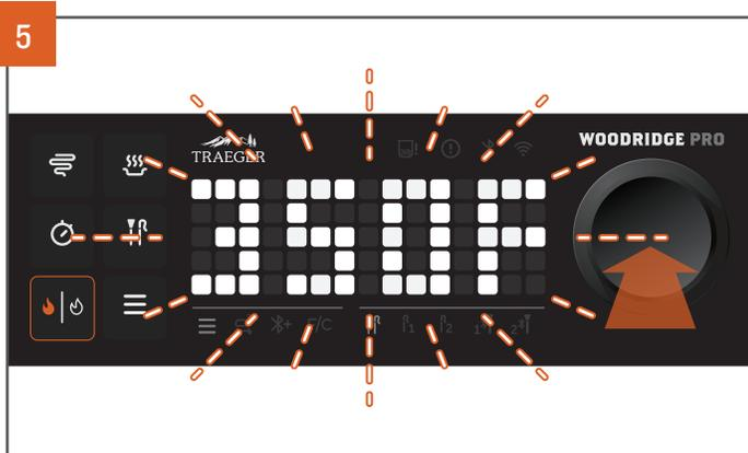
Lorsque la température clignote, appuyez au centre du cadran de sélection pour sélectionner la température souhaitée.
