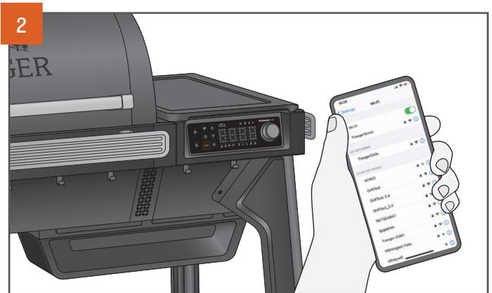
Assurez-vous que votre dispositif intelligent est branché au réseau Wi-Fi auquel vous voulez connecter votre barbecue. Le signal du routeur doit être en 2,4 GHz, car le barbecue n'est pas compatible avec le 5 GHz.
