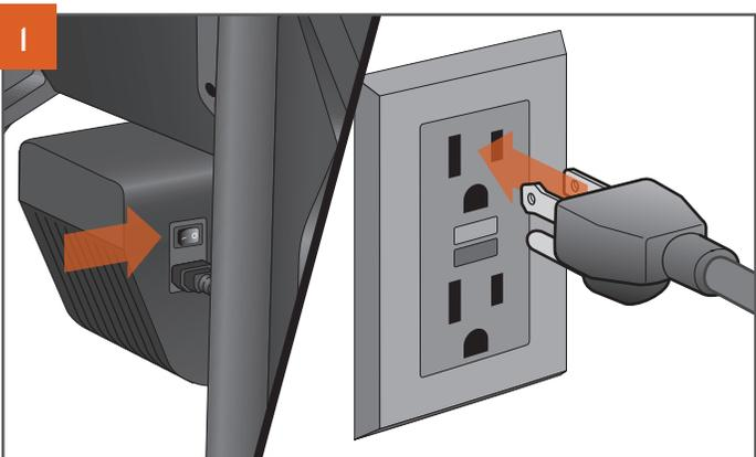
Lorsque l'interrupteur principal est en position OFF (ARRÊT) (0), branchez le cordon d'alimentation sur le barbecue. Branchez ensuite le cordon d'alimentation dans une prise électrique correctement mise à la terre et protégée par un disjoncteur différentiel de fuite à la terre (GFCI).
