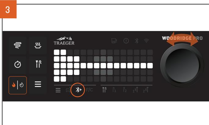
Dans le menu, tournez le cadran de sélection jusqu'à ce que l'icône Add Bluetooth<sup>MD</sup> Accessory (Ajouter un accessoire Bluetooth<sup>MD</sup>) s'allume dans la barre de menu et que l'animation de jumelage de la sonde ci-dessus s'affiche à l'écran.
