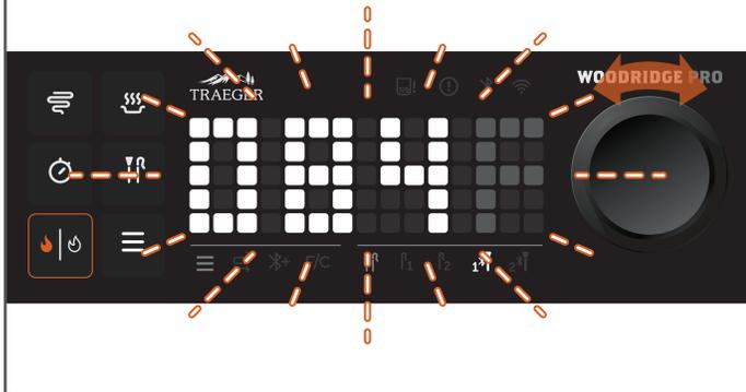
Après avoir appuyé sur le cadran de sélection, les chiffres à l'écran clignotent, indiquant que vous êtes en mode de sélection. Tournez le cadran de sélection jusqu'à la température cible interne souhaitée.
