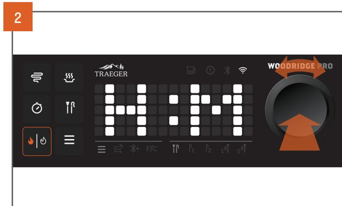
H et M clignotent brièvement, indiquant que vous pouvez régler les heures à gauche et les minutes à droite. Les heures clignotent en premier. Tournez le cadran de sélection jusqu'aux heures souhaitées, puis appuyez sur le cadran pour verrouiller les heures. Si vous ne souhaitez pas régler d'heures, appuyez sur le cadran de sélection lorsque l'écran affiche 00:00.
