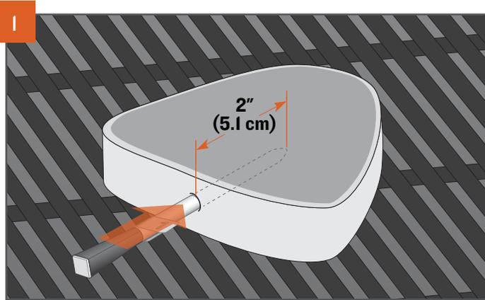
Insérez la sonde jusqu'à la rainure dans la partie la plus épaisse de la protéine – évitez de toucher les os ou les parties particulièrement grasses de la protéine. La sonde doit rester dans la protéine à au moins 5,1 cm (2 po). Cette sonde peut ne pas convenir si vous ne pouvez pas insérer la sonde de 5,1 cm (2 po) dans la partie la plus épaisse de la protéine. Après avoir inséré votre sonde, placez vos aliments sur le barbecue préchauffé.
