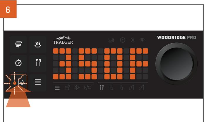
Une fois la température sélectionnée, la température passe du blanc à l'orange, ce qui indique que la température réglée est verrouillée. Le bouton d'allumage/arrêt clignote. Appuyez sur ce bouton pour démarrer l'allumage. Le barbecue s'allume et se préchauffe automatiquement pour atteindre la température que vous avez réglée.
