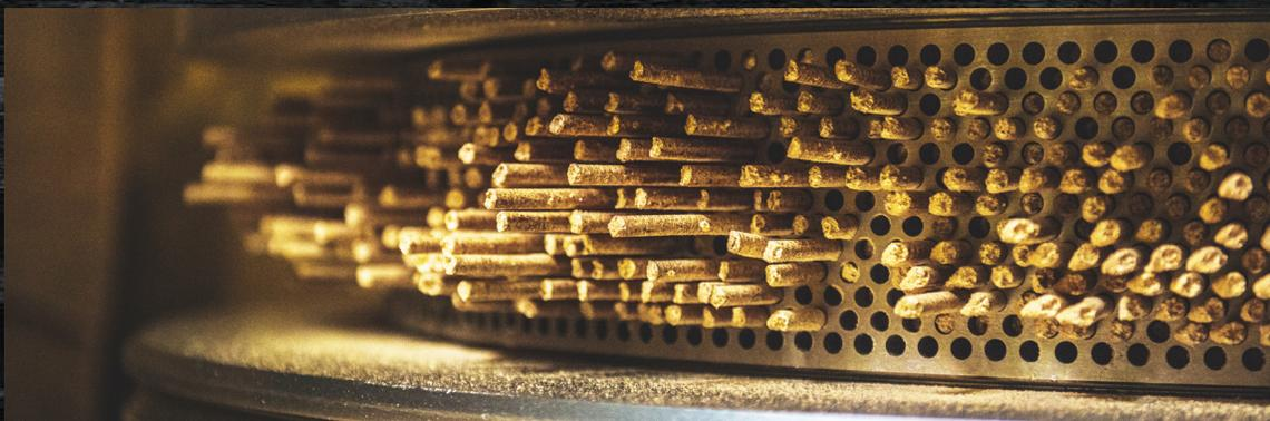
2 El serrín se comprime en pellets usando **calor y presión**.
