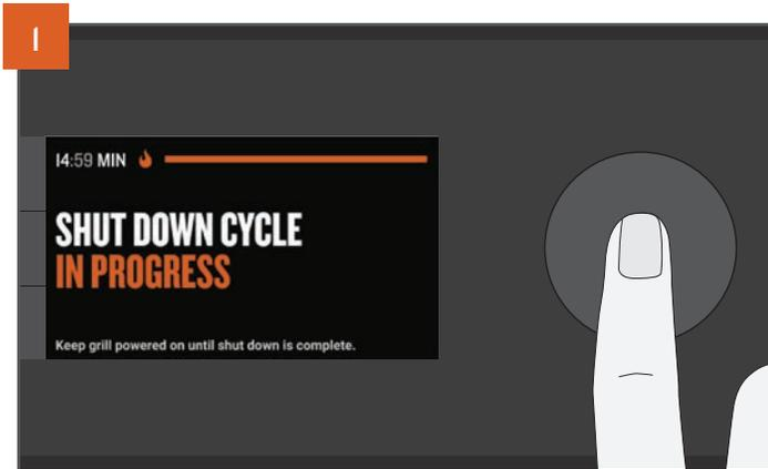
Drücken Sie den Auswahldrehknopf und halten Sie ihn 3 Sekunden lang gedrückt, bis der Bildschirm registriert wird und SHUT DOWN CYCLE IN PROGRESS (Abschaltzyklus wird ausgeführt) anzeigt.
