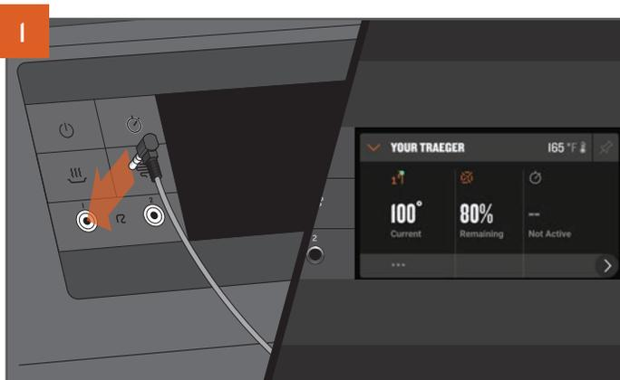
Informationen zum Einschalten des Grills finden Sie unter „Kochen auf dem Traeger“ auf Seite 20. Stecken Sie die Sonde in die Anschlussbuchse am WiFIRE-Controller ein. Sobald die Verbindung hergestellt ist, erkennt der Controller die Sonde und ein Sonden-Widget wird im Dashboard angezeigt.
