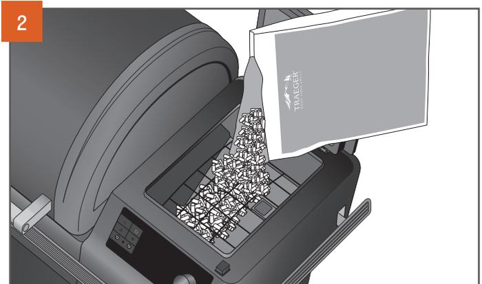
Öffnen Sie den Deckel der Pelletkammer. Achten Sie vor dem Einfüllen von Pellets in die Pelletkammer darauf, dass sich keine Fremdkörper in der Förderschnecke befinden. Schließen Sie nach dem Einfüllen der Pellets in die Pelletkammer den Deckel. Wir empfehlen, dass Sie die Pelletkammer mindestens bis zum Sicherheitsgitter in der Pelletkammer füllen.
