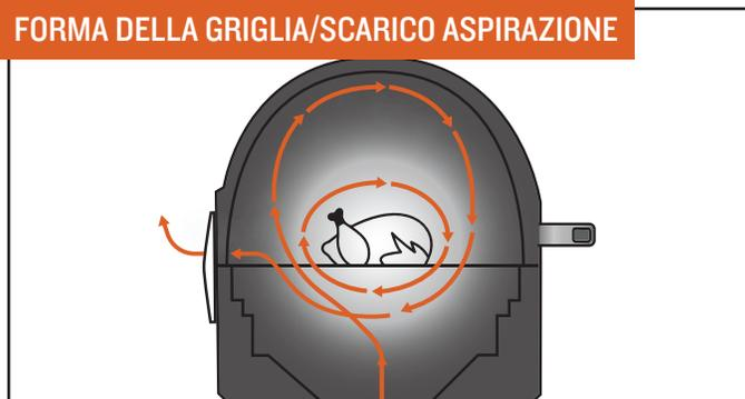
La forma tipica della griglia/dello scarico di aspirazione di Traeger crea un vortice di convezione. Fa circolare l'aria calda e affumicata intorno alla camera di cottura, circondando gli alimenti con il calore del legno per una cottura uniforme su tutti i lati. L'aria fumosa è sempre presente durante la cottura, anche se non la vedi.
