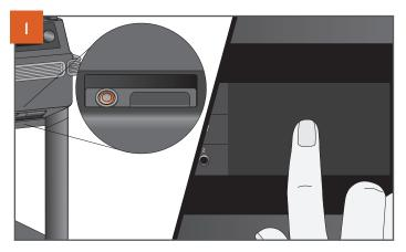
La porte fermée, appuyez sur le bouton d'alimentation principal situé l'avant du barbecue pour le mettre en MARCHE. Tapez sur l'écran ou tournez la molette de sélection pour activer le contrôleur. Une fenêtre d'attente apparaît après quelques secondes, lorsque le barbecue est sous tension.
