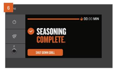
Lorsque le cycle de préparation est terminé, le contrôleur lance un cycle d'arrêt complet. Les cycles d'arrêt permettent d'éviter les effets indésirables futurs et de préparer correctement votre barbecue pour la prochaine cuisson.
