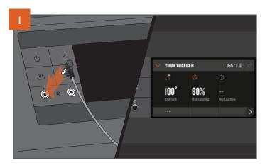
Voir « Cuisson sur votre Traeger » à la page 20 pour démarrer votre barbecue. Branchez la sonde sur le connecteur de sonde situé sur le panneau de contrôle WiFIRE. Une fois branché, le contrôleur reconnaît la sonde et un gadget logiciel de sonde apparaît dans le tableau de bord.
