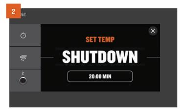
Pendant le réglage de la température, tournez le cadran de sélection complètement vers la gauche et appuyez pour sélectionner SHUTDOWN (cycle d'arrêt).
