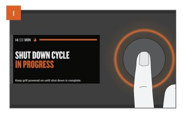
Appuyez sur le cadran de sélection et maintenez-le enfoncé pendant 3 secondes, jusqu'à ce que l'écran s'enregistre et affiche « SHUT DOWN CYCLE IN PROGRESS » (cycle d'arrêt en cours).
