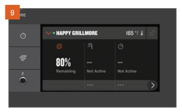
Appuyez sur la barre de bas de page en bas de l'écran d'accueil pour accéder au tableau de bord Traeger. À partir d'ici, au fur et à mesure que vous installez et utilisez les accessoires, vous pourrez contrôler les minuteries, définir les températures de cible de la sonde, examiner les niveaux de pellets, et plus encore.
