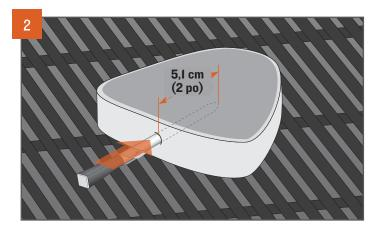
Insérez la pointe de la sonde jusqu'au cran, dans la partie la plus épaisse de la protéine – évitez de toucher les os ou les parties particulièrement grasses de la protéine. La sonde doit être enfoncée dans la protéine au moins 5,1 cm (2 po). Cette sonde peut ne pas convenir si vous ne pouvez pas insérer la sonde dans la partie la plus épaisse de la protéine et à 5,1 cm (2 po) de profondeur dans la protéine. Après avoir inséré votre sonde, placez vos aliments sur le barbecue préchauffé.
