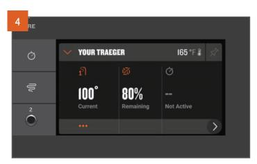
Si vous avez manqué la fenêtre contextuelle, vous pouvez définir une alarme de cible de sonde via le raccourci (...) dans le tableau de bord sous le gadget logiciel de la sonde, ou via les options Accessoires dans le menu.
