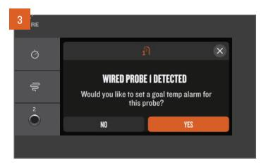
Pour cuire à une température interne, réglez une alarme de température cible pour la sonde. Lorsque vous connectez pour la première fois une sonde Bluetooth ou une sonde câblée, une fenêtre contextuelle proposera un raccourci permettant de définir facilement une alarme de température cible. Sélectionnez YES (oui) et suivez les instructions.
