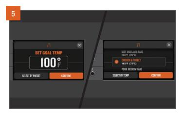
Utilisez le bouton de sélection pour choisir la température souhaitée pour l'alarme cible de sonde et appuyez sur le bouton pour sélectionner et confirmer. Vous ne vous souvenez plus de la température interne sûre pour le poulet au marsala ? Appuyez sur SELECT BY PRESET (Sélectionner par préréglage) pour trouver une liste des températures appropriées aux choix de protéines courantes.
