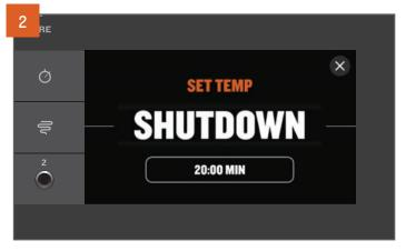
Pendant le réglage de la température, tournez le bouton de sélection complètement vers la gauche et appuyez pour sélectionner SHUTDOWN (cycle d'arrêt).
