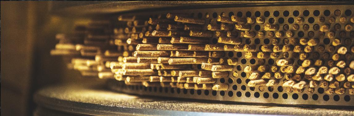
**2** Die Sägespäne werden durch **Hitze und Druck** zu Pellets gepresst.
