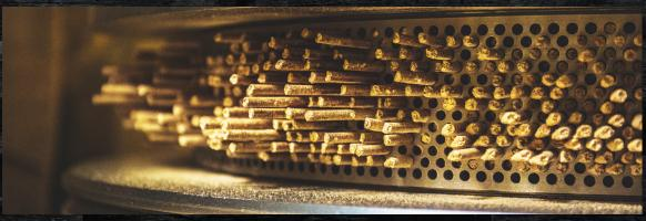
A serragem é comprimida em pellets usando calor e pressão.
