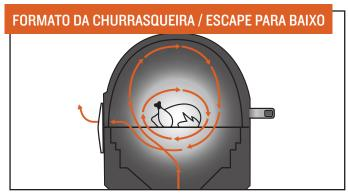
A forma de barril com a assinatura da Traeger cria um vórtice de convecção. Faz circular o ar quente e fumado à volta da câmara de cozedura, envolvendo a comida com calor a lenha para uma cozedura uniforme de todos os lados. O ar enfumaçado está sempre presente durante o cozimento, mesmo que você não o veja.
