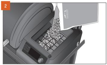
Feche a tampa do compartimento de alimentação. Certifique-se de que não há elementos estranhos no sem-fim antes de adicionar pellets à tremonha. Depois de adicionar pellets ao funil, feche a tampa do funil. Recomendamos que você encha a caçamba com pellets pelo menos até a grade de segurança da tremonha.
