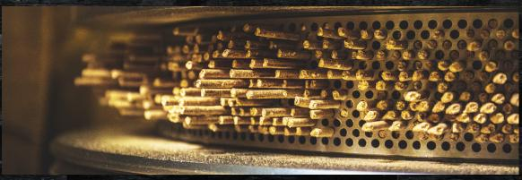
2 El serrín se comprime en pellets usando calor y presión.
