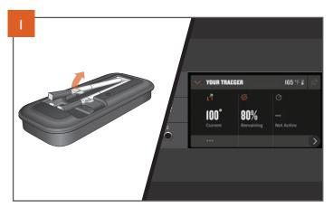
Vea "Cocinando en su Traeger" en la página 20 para encender la parrilla. Una vez que la parrilla esté encendida, retire una sonda Bluetooth Traeger cargada, de una en una, de la base de carga y el controlador reconocerá automáticamente cualquier sonda previamente acoplada. Aparecerá un componente gráfico de la sonda dentro del tablero de Traeger, donde puede encontrar información adicional sobre el estado de la sonda y accesos directos para configurar las alarmas de objetivo de la sonda.
