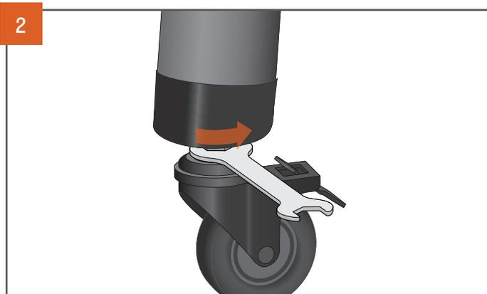
Serrez complètement le contre-écrou à l'aide d'une clé de 19 mm ou 3/4 de po pour verrouiller le nivellement. Le contre-écrou se trouve sous la jambe mais au-dessus de la roulette.
