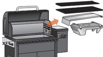
Racler la graisse accumulée à l'intérieur du drain à graisse en forme de « V » et du tube de drainage de la graisse à l'aide d'un outil non métallique rigide. La majeure partie de la graisse peut être poussée dans le tube de drainage de la graisse, et tombera dans le seau à graisse. Essayez les résidus de graisse avec des serviettes en papier ou des chiffons jetables.
