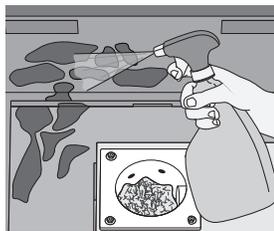
Retirez toutes les grilles, la cuvette d'égouttage à graisse et le système de collecte des cendres. Ceci permet d'avoir accès au drain à graisse en forme de « V » et à l'ouverture du tube du drain à graisse.
