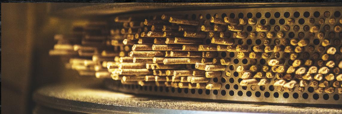
2 El aserrín está comprimido en pellets utilizando **calor y presión**.
