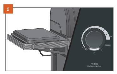
Sobald das Gerät eingesteckt ist, beginnen die Lichter über dem Bluetooth-Symbol am Drehknopf des Kochfelds zu pulsieren. Dies bedeutet, dass das Induktionskochfeld sein Signal sendet. Leuchten die Bluetooth-Lichter nicht auf? Versuchen Sie, das Gerät vom Grill zu trennen und wieder einzustecken.
