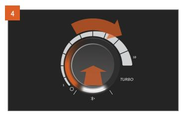
Um die Leistungsstufe zu ändern, drehen Sie einfach den Drehknopf auf die gewünschte Leistungsstufe und drücken Sie den Knopf, um die Auswahl zu bestätigen.
