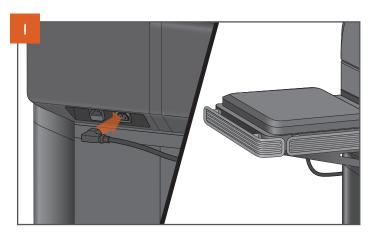
Schließen Sie das Traeger Induktionskochfeld an den Grill an, um sicherzustellen, dass es für die Kopplung bereit ist. Dieser Stecker befindet sich an der Rückseite des Grills hinter der Pelletkammer. Wenn sich der Netzschalter des Grills in der Position EIN befindet und das Induktionskochfeld eingesteckt ist, wird das Gerät eingeschaltet und die Bluetooth-Übertragung beginnt.
