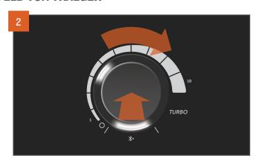
Drehen Sie den Drehknopf auf die gewünschte Leistungsstufe und drücken Sie ihn fest. Der Lichtring blinkt, bis Sie den Drehknopf drücken. Zum Kochen und Anbraten stellen Sie den Drehknopf auf TURBO.
