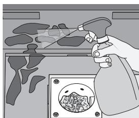
Retirez toutes les grilles, la cuvette d'égouttage à graisse et le déflecteur de chaleur. Ceci permet d'avoir accès au drain à graisse en forme de « V » et à l'ouverture du tube du drain à graisse.
