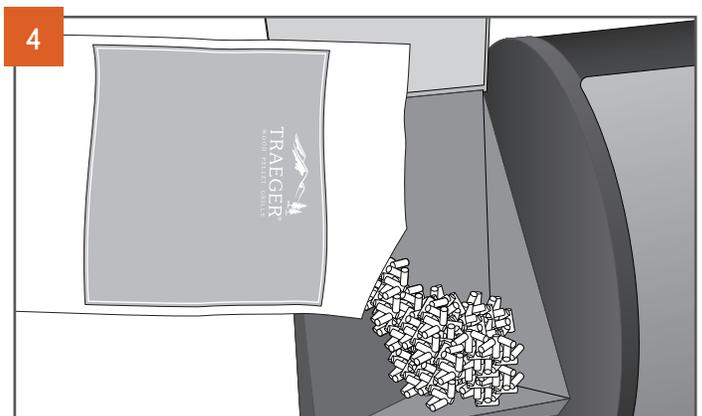
Ouvrez le couvercle de la trémie. Assurez-vous qu'il n'y a aucun corps étranger sur la vis sans fin avant avoir ajouté les granules dans la trémie. Après avoir ajouté les granules dans la trémie, fermez le couvercle. Nous recommandons que vous remplissiez la trémie à granules jusqu'au niveau sécuritaire de la trémie.
