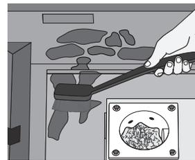
Grattez l'accumulation de graisse à l'intérieur du barbecue à l'aide d'un outil robuste et non métallique. La graisse est majoritairement nettoyée à l'aide d'une serviette de papier ou de linge jetable. Utilisez un aspirateur pour retirer l'excès provenant du grattage, décrit dans l'étape 4 (ci-dessous) après avoir nettoyé les cendres du creuset.
