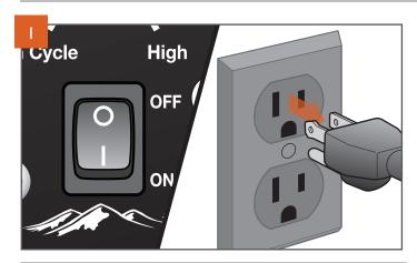
DANGER! IF THE GRILL FAILED TO LIGHT OR THE FIRE WENT OUT, TURN THE MAIN POWER SWITCH OFF (0) AND DISCONNECT THE POWER CORD. IF THE GRILL IS STILL HOT, ALLOW IT TO COOL THOROUGHLY.
