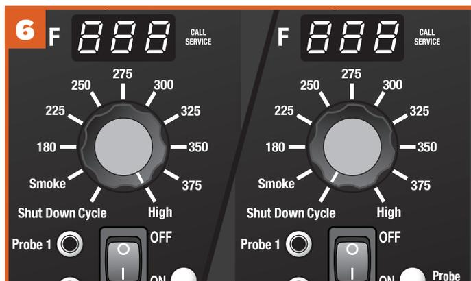
Tournez le bouton de sélection de la température à HIGH (élevée). Dès que les granules commencent à tomber dans le creuset, la vis sans fin est pleine. Tournez le bouton sur SHUT DOWN CYCLE (cycle d'arrêt) pour réinitialiser le processus d'allumage.
