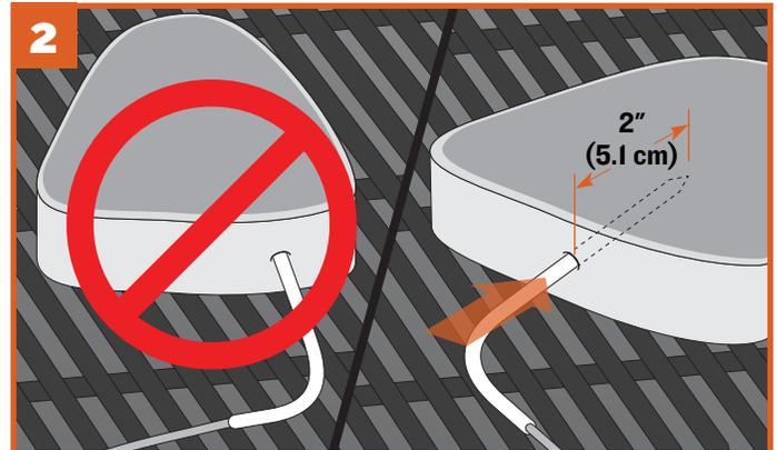
Insérez le bout de la sonde dans la partie la plus épaisse de la viande – pas dans le gras ni en contact avec un os. La sonde doit pénétrer d'au moins 5,1 cm (2 po) dans la viande. Cette sonde peut ne pas convenir si vous ne pouvez pas l'insérer dans la partie la plus épaisse de la viande et d'au moins 5,1 cm (2 po) de profond.
