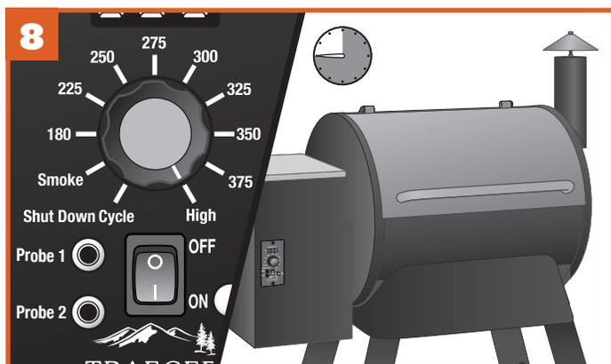
Avant d'utiliser votre barbecue pour la première fois, il devra être préparé. Tournez le cadran de sélection de la température à ÉLEVÉ et laissez chauffer pendant 45 minutes avec la porte fermée. Après la préparation, tournez le bouton sur SHUT DOWN CYCLE (cycle d'arrêt) et laissez le barbecue fonctionner jusqu'à ce qu'il soit entièrement arrêté. Votre barbecue est maintenant prêt pour la cuisson.
