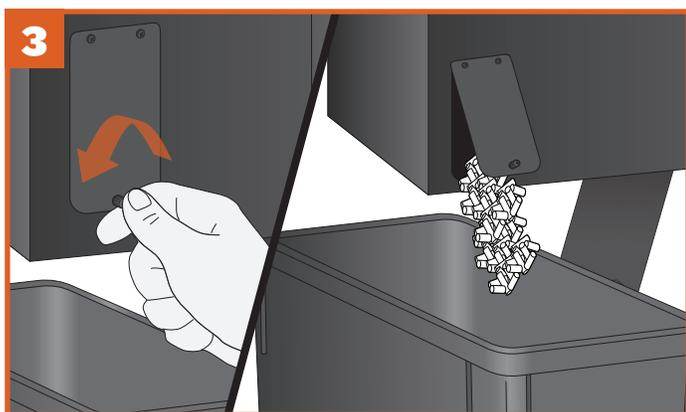
Dévissez la vis de trappe de vidange et ouvrez-la. Les granules se videront dans le contenant que vous avez placé juste en dessous. Utilisez au besoin une spatule ou une cuillère pour retirer tous les granules de la trémie.
