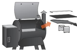
Grattez l'accumulation de graisse à l'intérieur du baril à l'aide d'un outil rigide non métallique. La majorité de la graisse grattée peut être enlevée en utilisant des serviettes de papier ou de chiffons jetables. Si un trop grand volume de résidus est gratté, ces résidus peuvent être nettoyés en utilisant un aspirateur comme décrit à l'étape 4 (page 24) pour le nettoyage des cendres dans le creuset.
