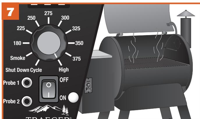
Une fois l'interrupteur d'alimentation sur ON (marche/II), tournez le bouton de sélection de la température à HIGH (élevée). Après environ deux minutes, une fumée gris-blanchâtre sortira du barbecue au fur et à mesure que les granules s'enflamment.
