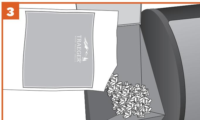
Ouvrez le couvercle de la trémie. Assurez-vous qu'il n'y a aucun corps étranger sur la vis sans fin avant d'ajouter des granules dans la trémie. Après avoir ajouté des granules dans la trémie, fermez le couvercle de la trémie. Nous vous recommandons de remplir la trémie de granules au moins jusqu'à la grille de sécurité de la trémie.
