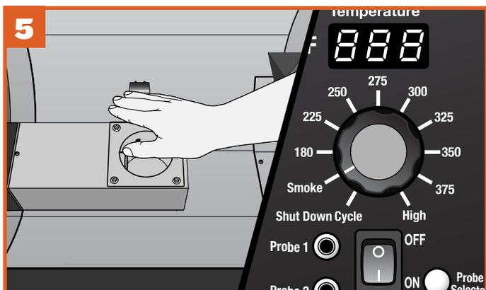
Placez vos doigts au-dessus du creuset pour sentir le mouvement de l'air provoqué par le ventilateur à tirage induit. Regardez le dispositif d'allumage pour voir s'il se réchauffe (il commencera à rougir).
