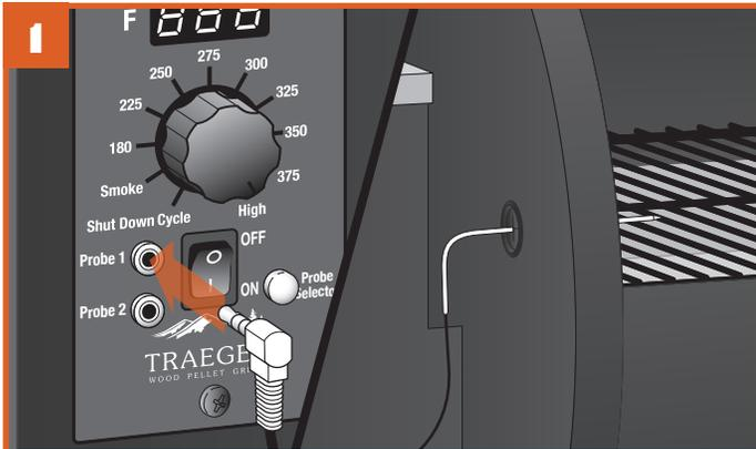
Insérez 1 ou 2 sondes à viande dans les trous d'insertion dans le coin inférieur gauche du panneau de commande, puis passez les fils des sondes à travers le trou d'accès sur le côté gauche du baril du barbecue.
