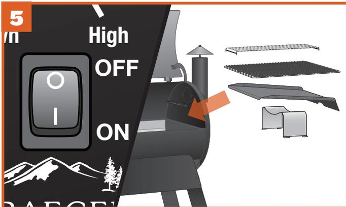
Lorsque les flammes commencent à sortir du creuset, mettez l'interrupteur d'alimentation principal sur OFF (arrêt/0). Laissez le barbecue refroidir complètement. Placez le déflecteur de chaleur, le plateau d'égouttement à graisse et les grilles dans le barbecue.
